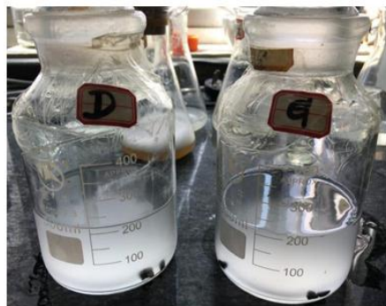
试验前：D 瓶钡锶垢、G 瓶重晶石
