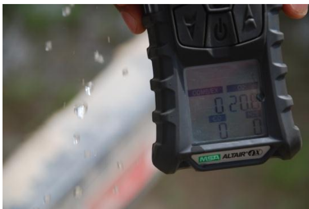
有毒有害气体现场检测
